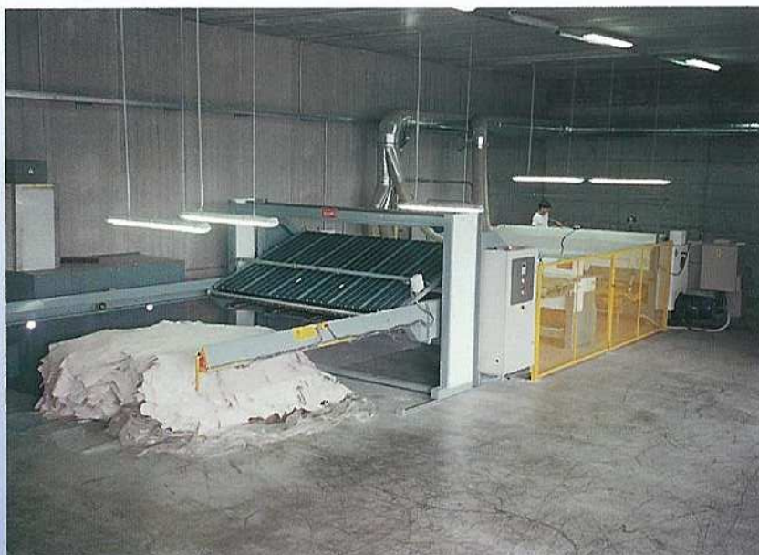
Abbinamento impilatore con linea a smerigliare Stacker connected to buffing line
