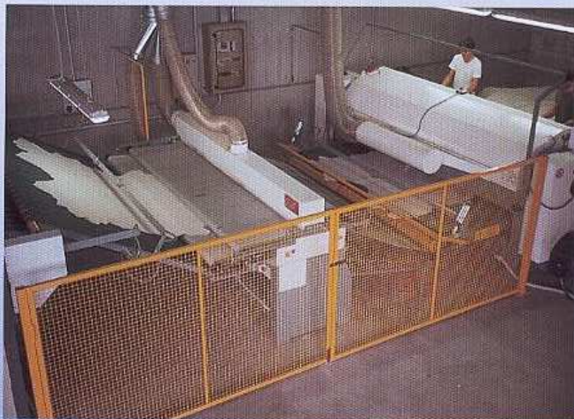
Abbinamento impilatore con linea a smerigliare Safety devices on buffing line
